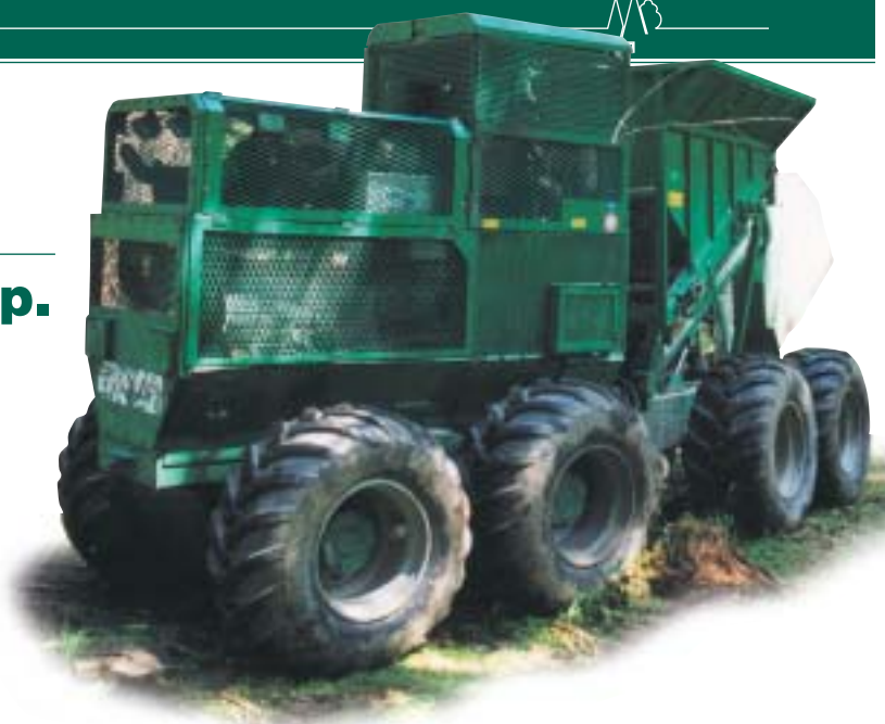
Dálkově řízený traktor, který naorává půdu a současně do ní zapracovává dolomitický vápenec, se zkouší v imisně poškozených oblastech při přípravě půdy pro obnovu lesních porostů
