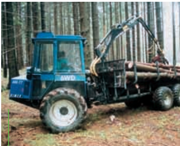
Vyvázečská souprava Vimek vhodná do probírkových porostů
