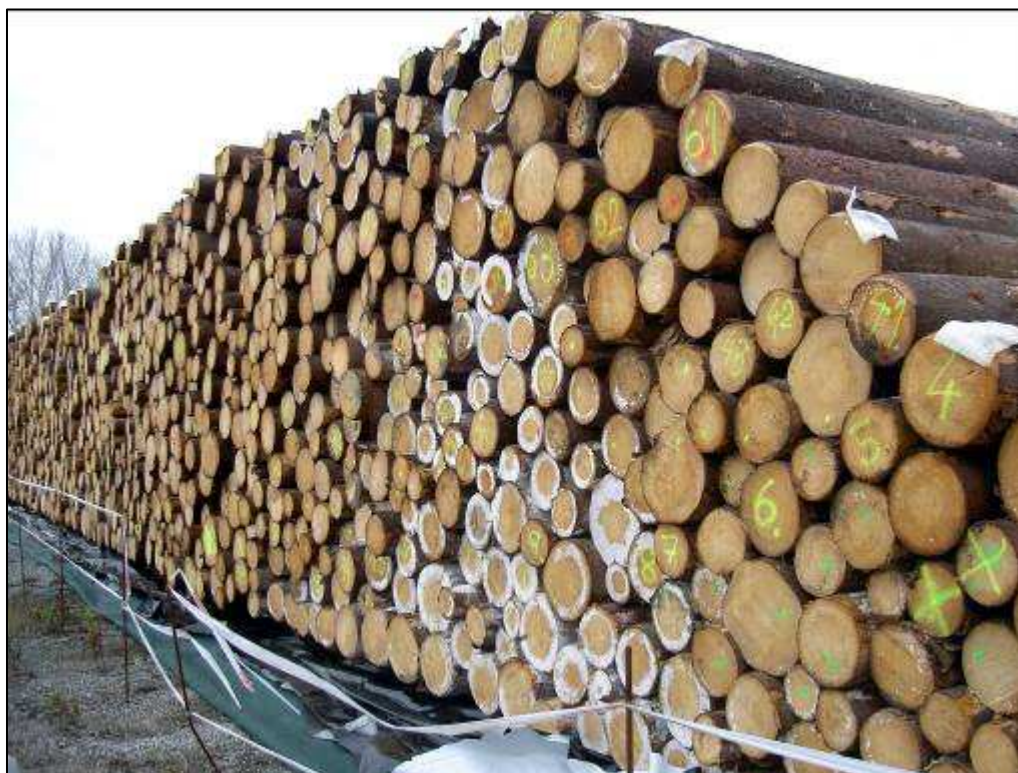
Obrázek 1: Stav okamžitě po rozbalení III. hráně. Zřetelná jsou místa s výskytem plísní
