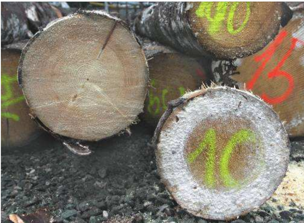
Obrázek 4: Čelo po odřezání kotoučku s napadením plísní. Dřevo nevykazuje příznaky poškození
