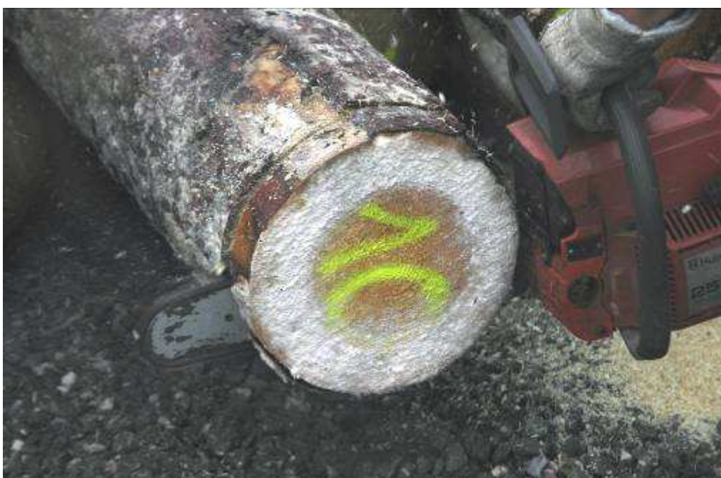
Obrázek 3: Odřezávání čela výřezu motorovou pilou pro posouzení hloubky napadení plísní. V případě posuzování plísně jako vady je výřez hodnocen jako kvalita D
