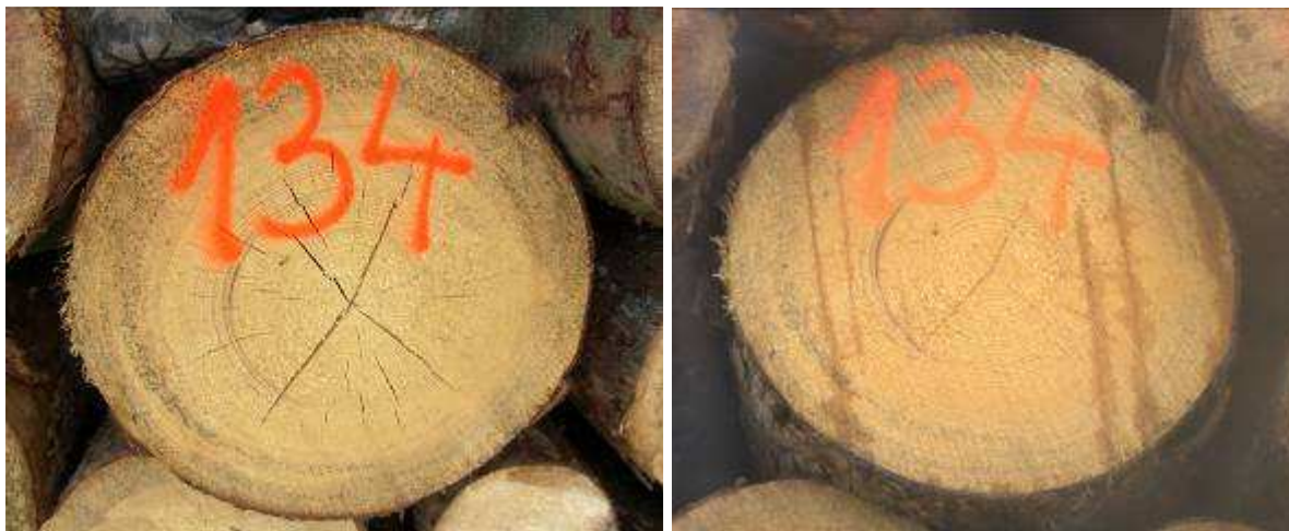
Obrázek 8: Výřez 134 na začátku a na konci doby skladování. Příklad „zatažení“ prasklin – hraně č. III
