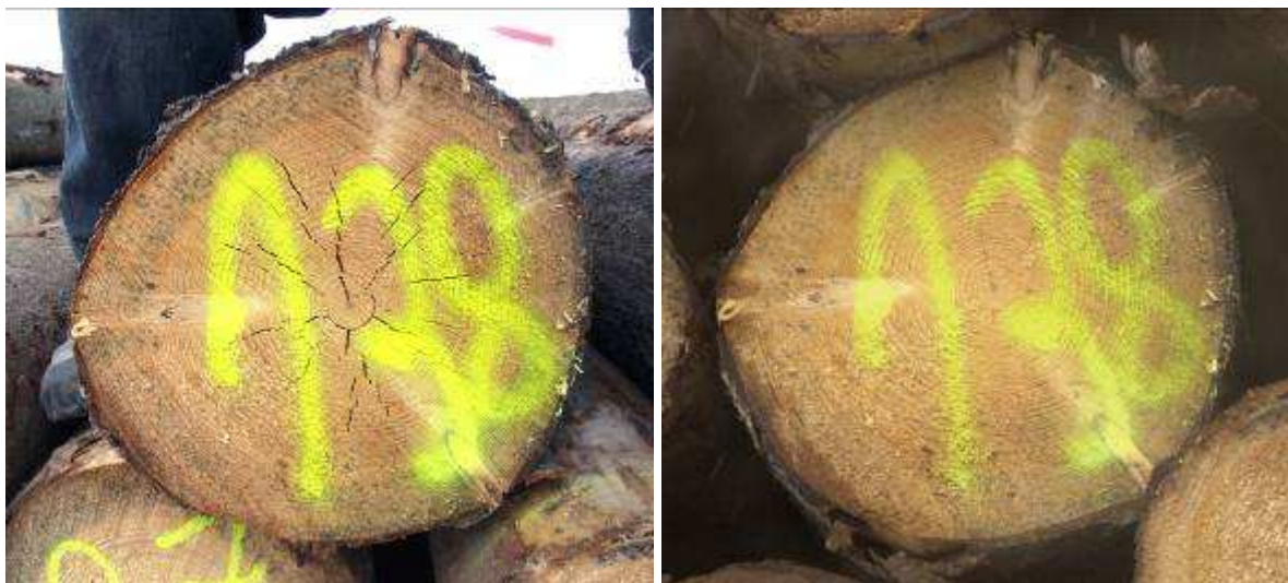
Obrázek 9: Výřez 138 na začátku a na konci doby skladování. Příklad „zatažení“ prasklin – vzorek z hraně č. III
