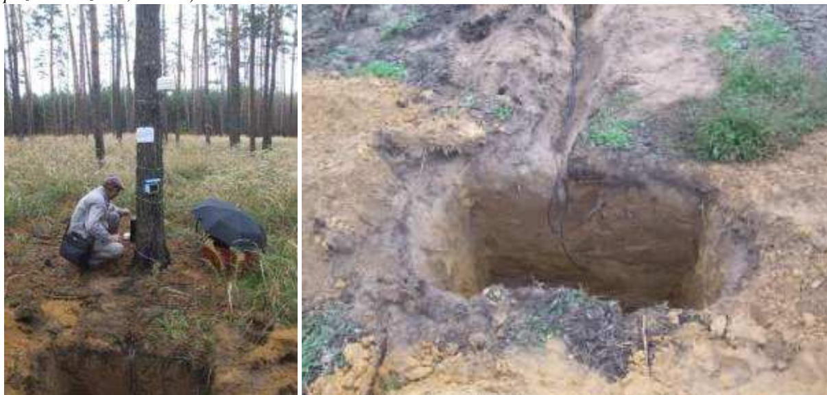
Obr. 15: Meteorologická stanice s polohou teplotních čidel k zachycení půdní a vzdušné teploty (porost 274A9, požářiště Bzenec, X/2013)
