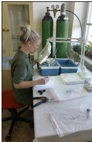
Obr. 5: Měření vodního stresu PMS tlakovou komorou
