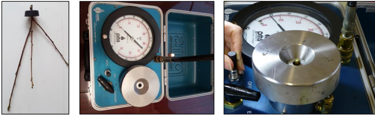
Obr. 4: Vybavení pro měření vodního stresu PMS tlakovou komorou
