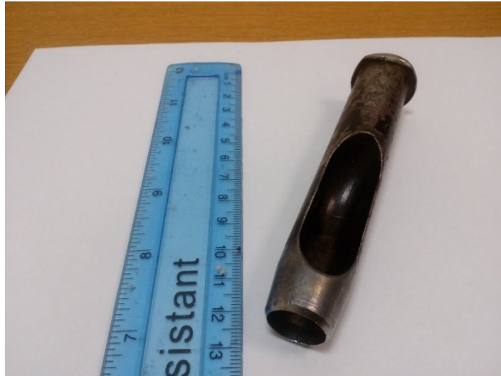
Obrázek 1 Ocelový průbojník (průměr 14 mm)
