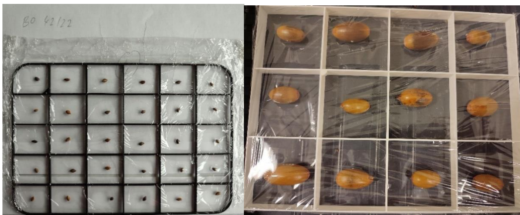
Obrázek 5. Semena borovice v mřížce (levý obrázek), upevněná mezi dvěma vrstvami průhledné fólie, a semena dubu v mřížce (pravý obrázek), upevněná přilepením na průhlednou lepicí pásku a přikrytá vrstvou průhledné fólie.
