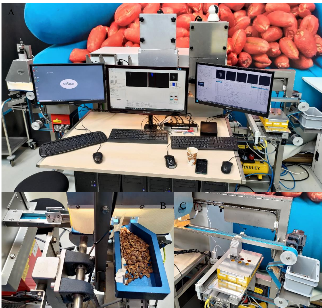
Obrázek 15. Laboratorní třídič využitý pro zkušební třídění semen jedle a ověření kvality třídícího algoritmu. A - celkový pohled na třídič, B – zásobník tříděných semen a podavač na pohyblivý pás, C – koncová rozdělovací část, nerozpoznaná semena padají do nádoby na konci pásu a vrací se do třídění.
