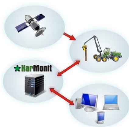
Obr. 8: Schéma přenosu dat v rámci technologického řešení HarMonit .
