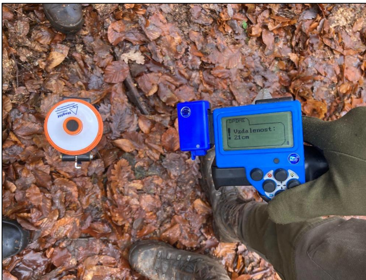
Příloha č. 18 – princip vytyčování kruhové zkusné plochy pomocí elektronické registrační průměrky s ultravukovým adaptérem a ultrazvukové odrazky
